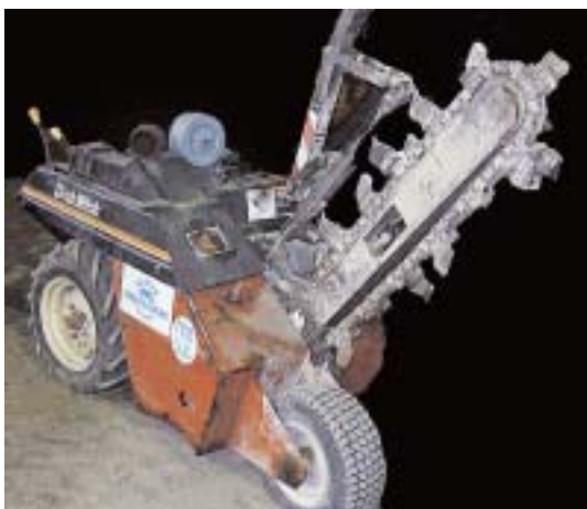
En kedjegrävare kostar ca 150 000 kronor i inköp och gräver 10-20 meter per timme på bra mark.
