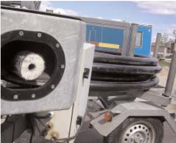
Flexibla rör finns både i singel- och tvillingutförande. Bilden visar singelrör.
